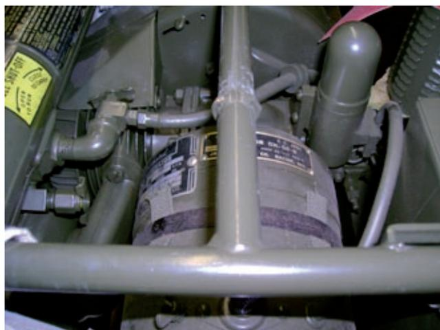
Notare la fascia di contenimento per il trasporto sul generatore
