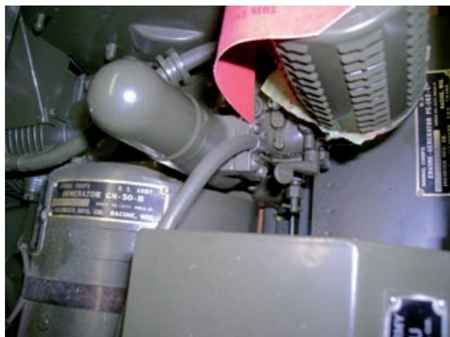
Carburatore. Notare la levetta dello Starter (aria)
