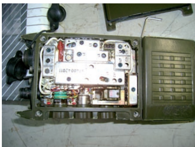
SEM 52A lato anteriore. Notare la quarzifera e la strana forma dell'involucro da quarzo.
