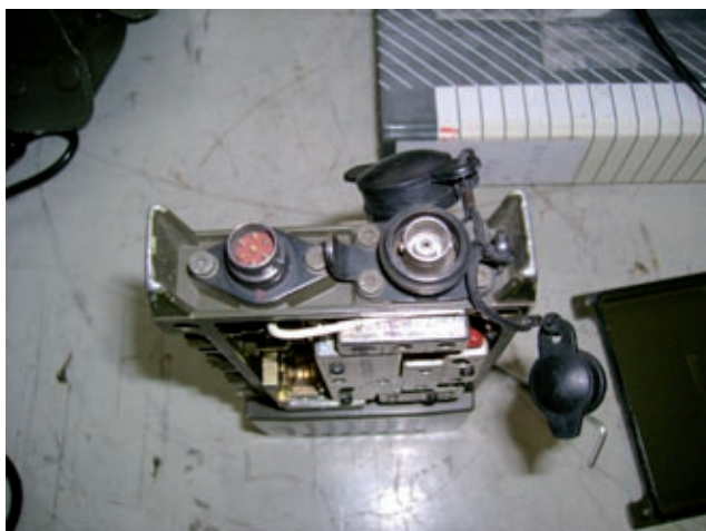
SEM 52A lato superiore. Attacchi antenna e microfono.
