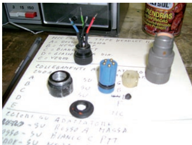
Adattatore smontato nelle sue parti.
