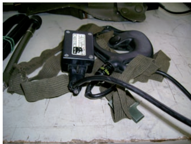
Microauricolare. Notare il cavo tagliato sul PTT
