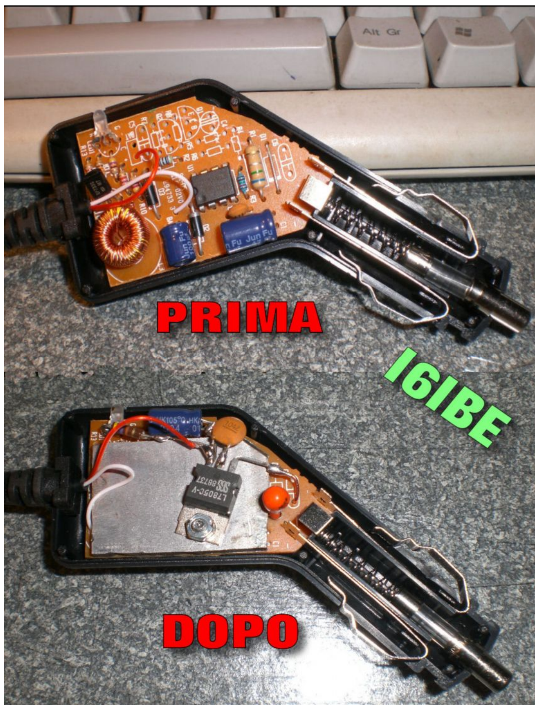
Alimentatore 5 volt per VX3 ricavato da un ex caricabatteria per cellulari
